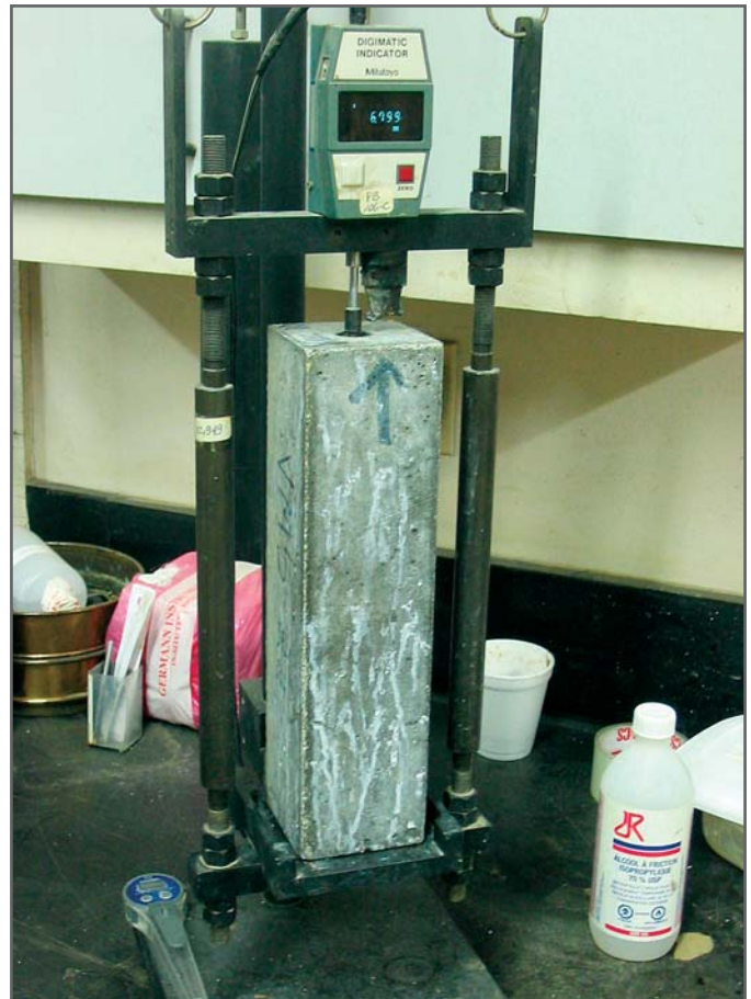
Test de réactivité alcalis-granulats mesurant les changements de longueur des échantillons en forme de prisme.
