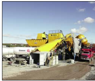
Le béton prêt à l'emploi a été fabriqué dans l'usine mobile installée près du chantier.
